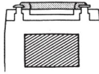
Am Fahrzeuboden eine ebene Klebefläche schaffen. Bei manchen Fahrzeugtypen (meist Drehgestellfahrzeuge) kann es notwendig sein, den Fahrzeuboden entsprechend auszusägen. Die Kulissenmechanik, auf dem Fahrzeuboden bzw. Chassis bzw. Beschwerung mit einem handelsüblichen 2-Komponenten-Kleber (z. B. UHU-plus Sofortfest) befestigen.
